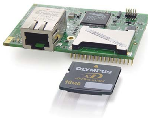
Рис. 3. Внешний вид процессорных модулей RCM3360/70
