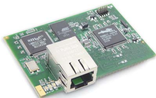
Рис. 2. Внешний вид процессорных модулей RCM3300/10
