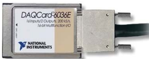
Рис. 1. Модуль сбора данных DAC компании National Instruments
